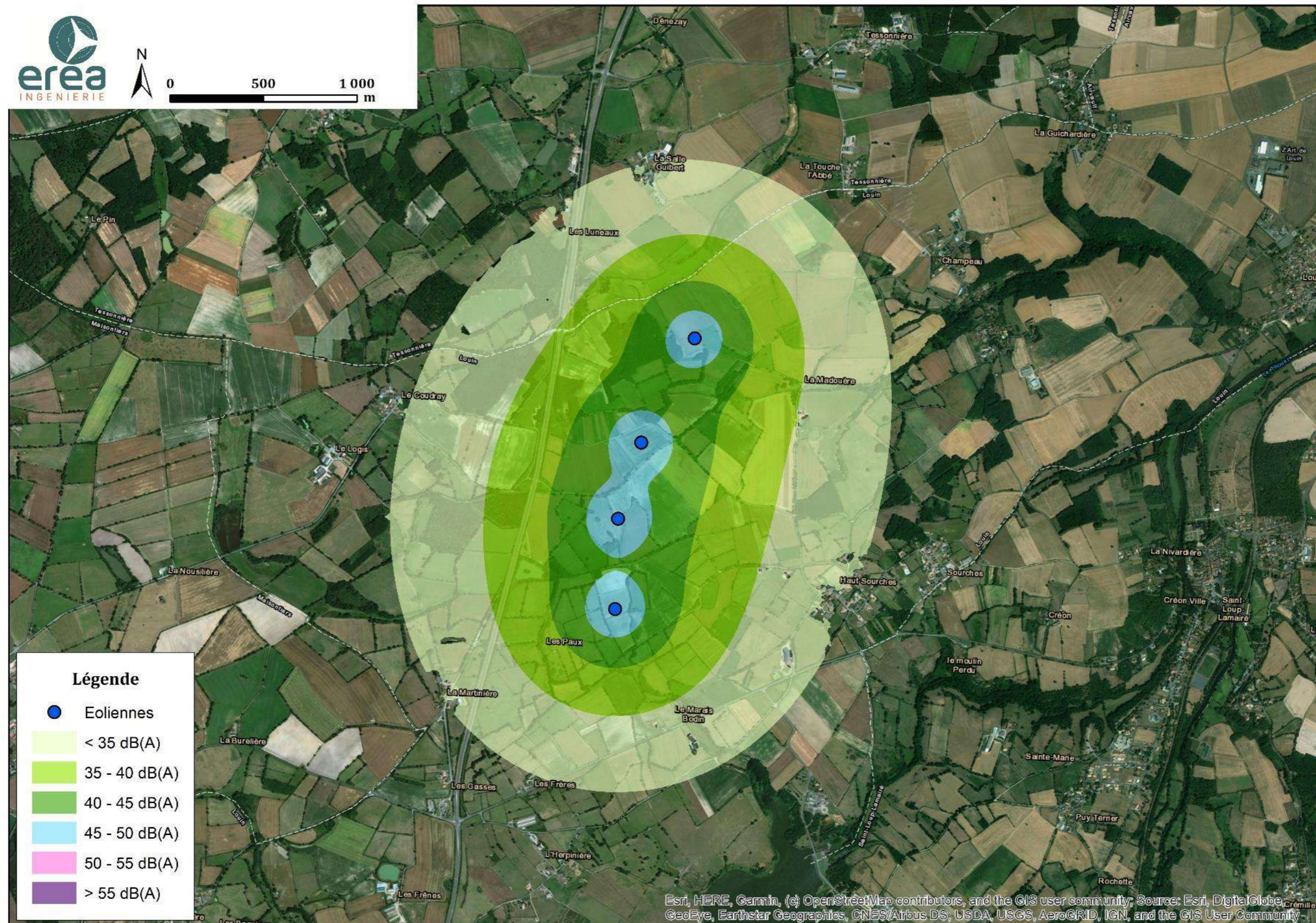
Carte 226 Isophones pour l'implantation de 4 éoliennes de modèle N149 pour un vent de vitesse standardisée de 5 m/s (toutes directions)
